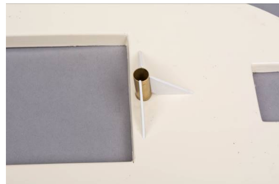
Abb. Maststütze mit Sekundenkleber geheftet
