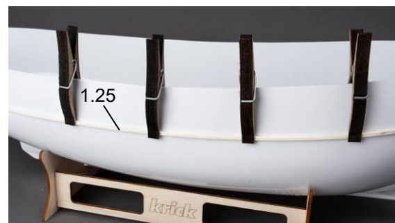
Abb. Scheuerleiste mit Klammern fixieren
