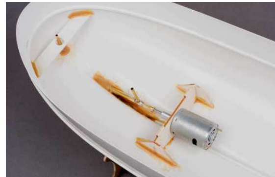
Abb. Antrieb im Rumpf verklebt
